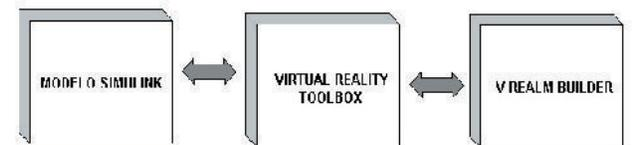
Fig. 18. Diagrama de bloques de la interacción entre simulink® y mundo virtual.
